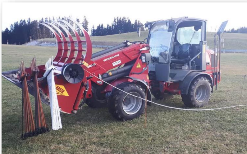
Haltevorrichtung für Pfähle und Haspelhalter an einer Schaufel fixiert, inkl. aufmagazinierter Pfähle
